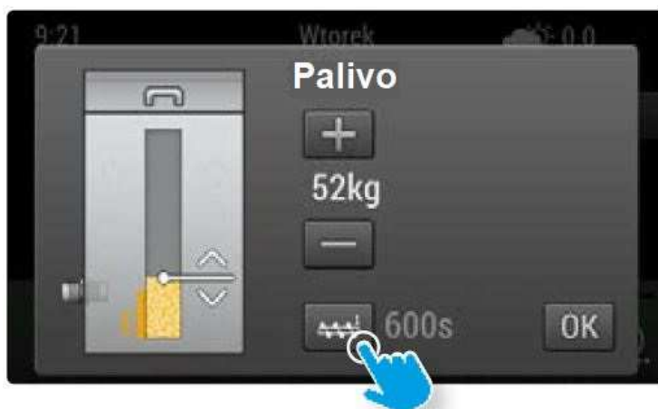
Obr. č. 35 – Měření vydatnosti paliva
